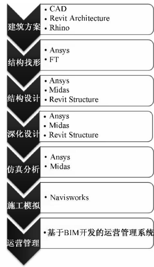
图 1 BIM 实施技术路线
